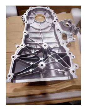
各类铸件的浸渗\*\*主要的功效是密封防漏,以使它能用于液压系统和燃气系统中。例如汽车变速箱体、燃油泵、液压阀、化油器、油缸、水泵、转向助力器、刹车泵、压缩机和液压部件、密闭的飞机仪器及其电子仪器护罩、气动零件和各种气动仪表等。
